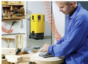
El equipo compacto SXC reúne bajo su carcasa un compresor de tornillo, un secador frigorífico y un depósito de aire comprimido de 215 l en un espacio muy reducido. Su emisión sonora de un máximo de 69 dB (A) lo convierte, además, en una máquina muy silenciosa.
