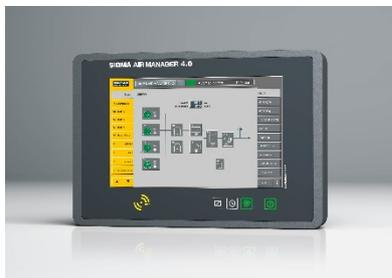
El Sigma Air Manager 4.0 monitoriza y controla todos los componentes de la estación de soplantes de la manera más eficiente posible, y además, los prepara para la industria 4.0.
