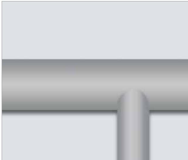
Imagen 3: Salida de la tubería directamente hacia abajo.
