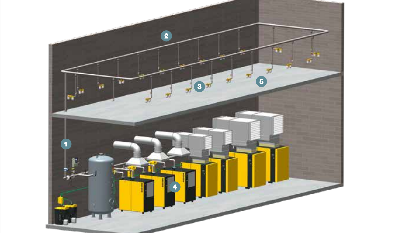
Imagen 1: Componentes principales de un sistema de distribución de aire comprimido: tubería principal (1), tubería de distribución (2), tubería de conexión (3), secador (4), unidad de mantenimiento/manguera (5).
