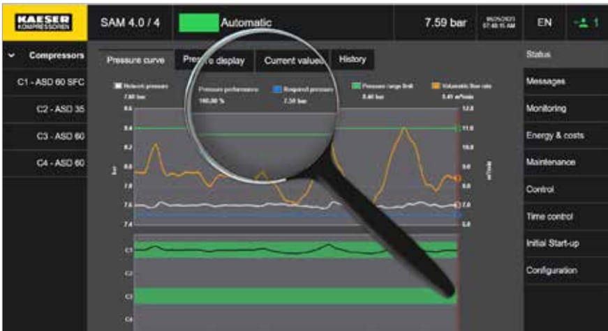
Imagen 5b: Gráfico de flujo volumétrico y presión con monitorización de la calidad de la presión.
