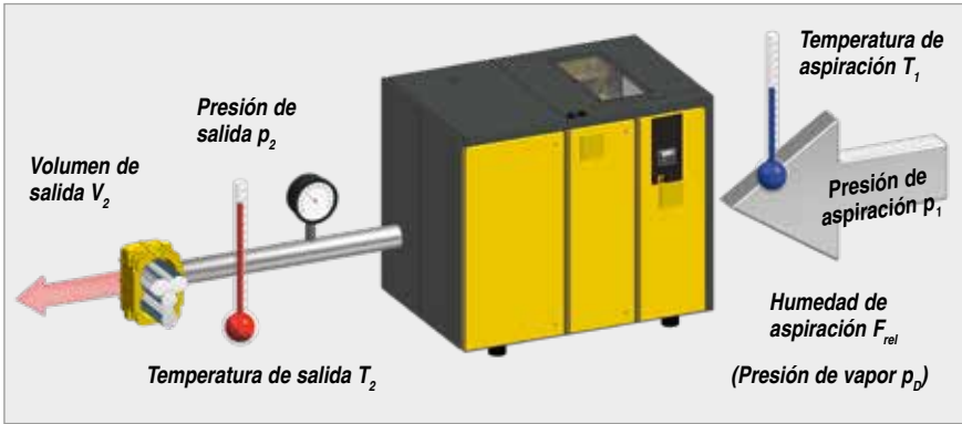
Imagen 1: Medición del flujo volumétrico según ISO 1217, anexo C.
