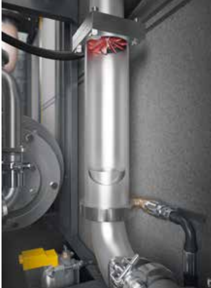
Imagen 2b: Separador ciclónico integrado con purgador de condensado.
