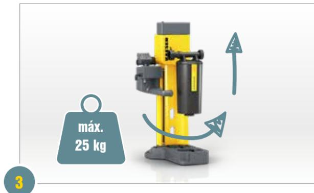
El cartucho se extrae del cierre de bayoneta girándolo 45° por su asa ergonómica y tirando hacia arriba. Pesa en estado totalmente saturado 25 kg como máximo .
